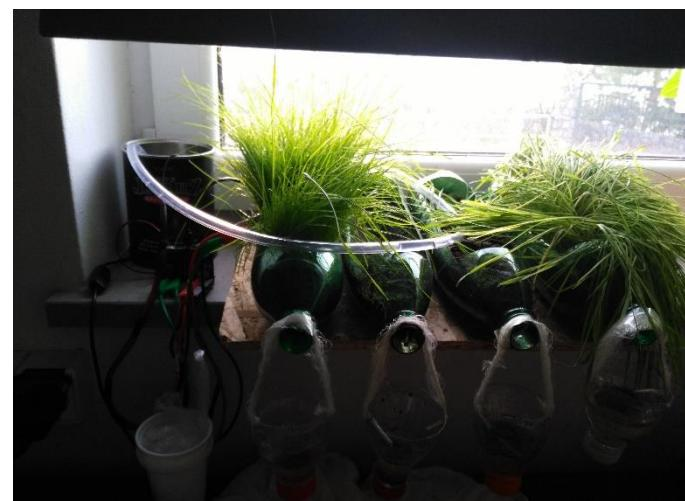
Vlažnost zemlje koju očitava Micro bit kreće se od 94 do 100%. Trava je redovito zalijevana putem Mikro bita. Pšenica polako ugiba.
