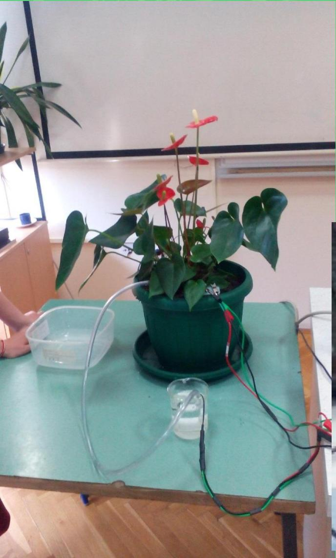
Micro:bit je senzorom izmjerio malu količinu vlage te uključio pumpicu za zalijevanje.
