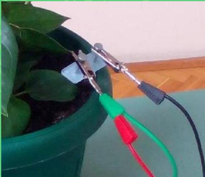
Micro:bit može izmjeriti vlagu u zemlji. Spojen je na senzore za vlagu – dva čavla zabodena u zemlju.
